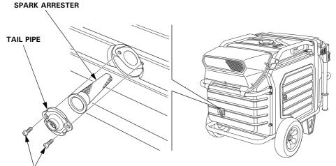
$<sup>5 \</sup>times 16 \text{ mm}$  PAN HEAD SCREW (2)
